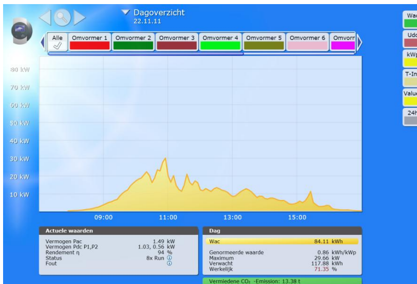
Figuur 2.4: Voorbeeld digitale uitlezing online monitoringssysteem
